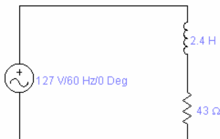
Figura 10 – Modelo Equivalente Real da Bobina do Contator Fabricante “B”
